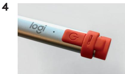
Faites glisser l'anneau du capuchon sur le tube du stylo jusqu'à ce que l'encoche s'insère dans la fente.
