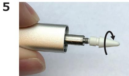
新しいチップを差し込み、時計回りに回してしっかりと締めます。
