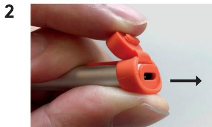
Työnnä suojus taakse ja vedä suojuksen rengas varovasti irti kynän rungosta.
