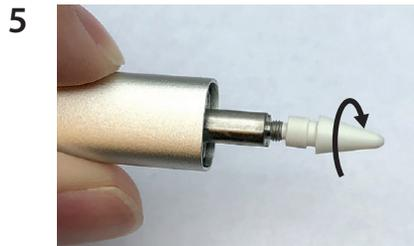
Вставьте новый наконечник и поворачивайте его по часовой стрелке так, чтобы он надежно зафиксировался.
