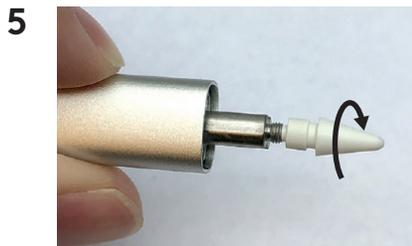
Setzen Sie die neue Spitze ein und drehen Sie diese dann im Uhrzeigersinn fest.
