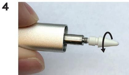
Tournez la mine dans le sens contraire des aiguilles d'une montre pour la retirer.
