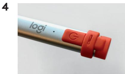
Skjut locket på pennröret tills slitsen passar runt skåran.
