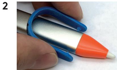
Vyrovnejte nástroj proti dvěma otvorům v tubusu pera.
