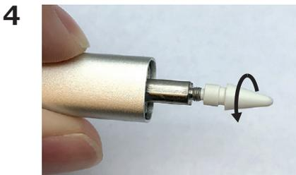
チップを反時計回りに回して取り外します。
