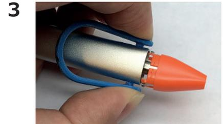
ツールを押し込み、チップカバーを引き抜きます。
